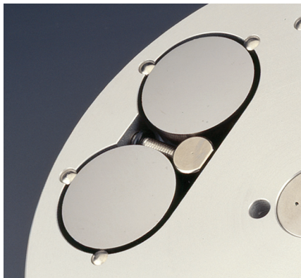
Doppelbefestigung – zwei Proben werden mit einer einzigen Schraube befestigt.
