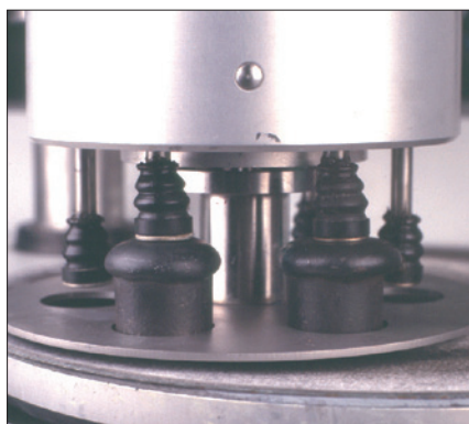
図13: 鑄造ラインにおける品質管理試料の半自動琢磨用試料ホルダー
