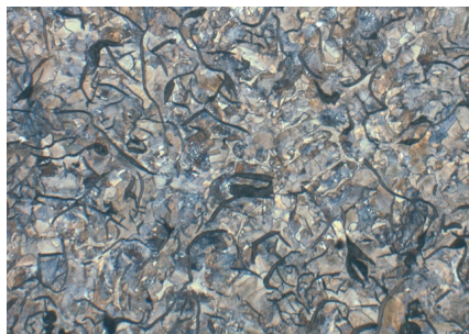
図4: パーライト素地に片状の黒鉛を含むねずみ鑄鉄 200x
