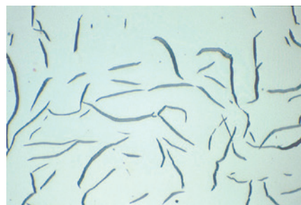
図14: 十分に研磨された片状黒鉛 500x
