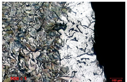
図17: 図16と同じ試料、MD-ラルゴとダイヤモンド砥粒による精研磨で作製された。エッジが良好に保持されている
