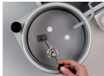
Couvercle pour le collage des échantillons destiné à la réalisation de lames minces
