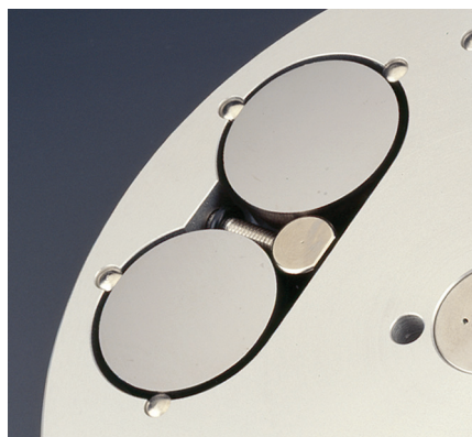
双夹持 - 使用单个螺钉紧固两个试样
