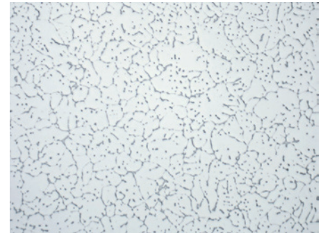
Abb. 3: Aluminiumlegierung 2024, gegossen, eutektische Ausscheidungen an Korngrenzen, nicht geätzt, 200x.
