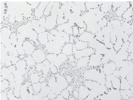
Abb. 10: Gefüge wie in Abb. 9, aber endpoliert mit OP-U Suspension. Die Matrix ist gut poliert, das Eutektikum hat mehr Kontrast. 200x
