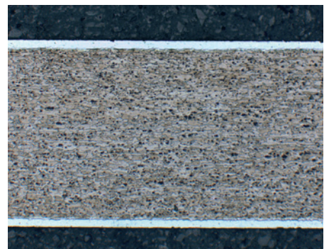
Plattiertes Blech, Kern: 50x Aluminiumlegierung 2024, Plattierung: Aluminium 99,5 %, geätzt mit Dix und Keller.
