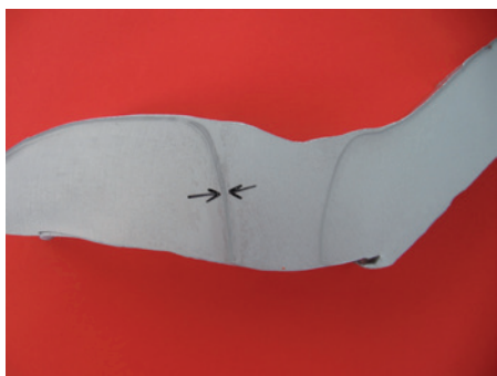
Abb. 13: Pressstück, Makroätzung, primäre und heterogene Ausscheidungen erkennbar, die sich negativ auf die Oberfläche des Endprodukts auswirken.
