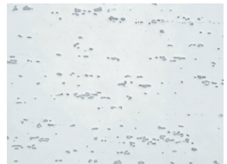
Abb. 5: Wie Abbildung 4, warmgewalzt, nicht geätzt, 200x.
