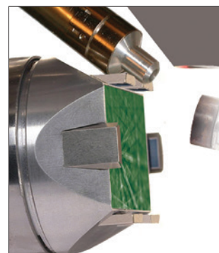
Der Nordlys EBSD Detektor in der REM Kammer. Mit freundlicher Genehmigung von Oxford Instruments plc.
