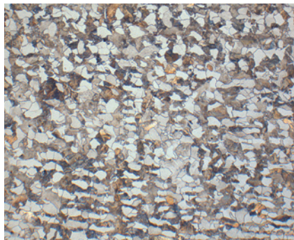
Abb. 7: C45 Stahl, geätzt mit 3 % Nital. Weißer Ferrit und dunkler Perlit. Hellfeld, Originalvergrößerung 200x.
