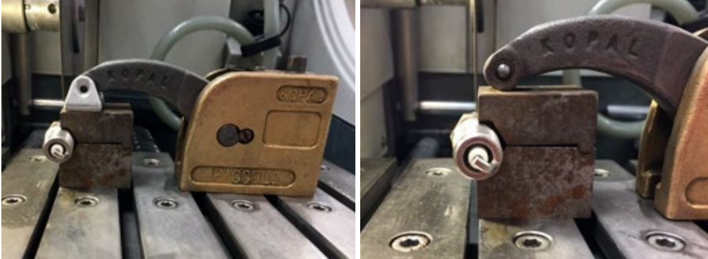
図2:特殊クランピング工具と専用バイスを使用した様子クランプにスィベルシューを使用した、切断の品質には大きな違いはなかった
