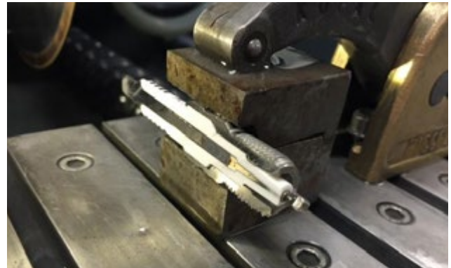
図1: 試料にダメージを与えることなくスパークプラグを半分に切断した最終結果
