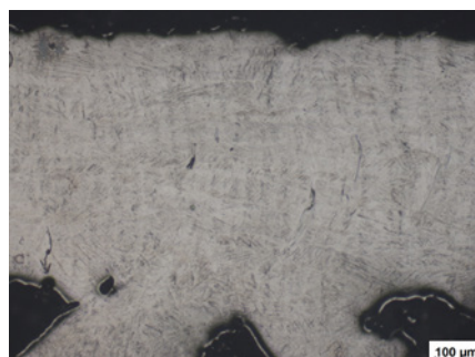
図15: 明視野モードでのチタン合金。A3 で電解研磨、埋込みなし、明視野。
