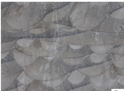
図25: Adler エッチング液でエッチングされたインコネル 718。明視野。
