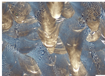
図27: 変性クレムエッチング液 (10/3) でエッチングし、塩化水素を添加した 工具鋼 1.2709
