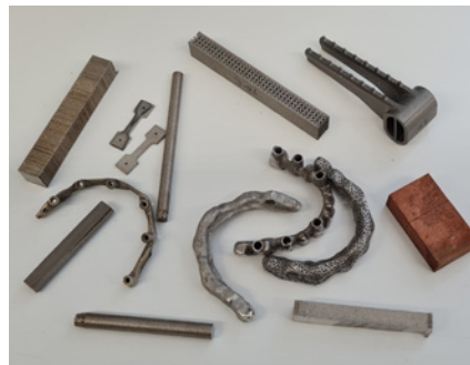
図8: 積層造形による金属試料の多様性(レーザー溶融プロセス)
