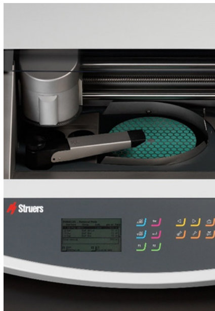
図30: ストルアスのターゲットマスターで材料除去を制御。
