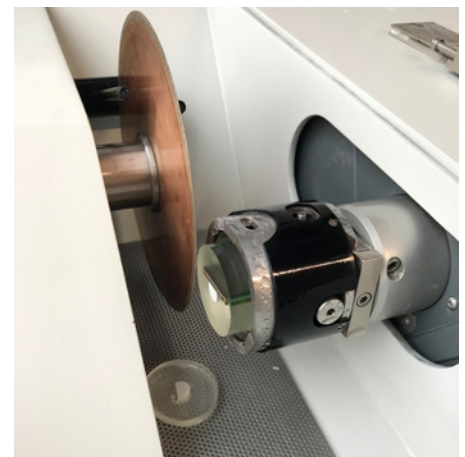
Trennen mit der Accutom Präzisionstrennmaschine – nah am Ziel und ohne Verformung.
