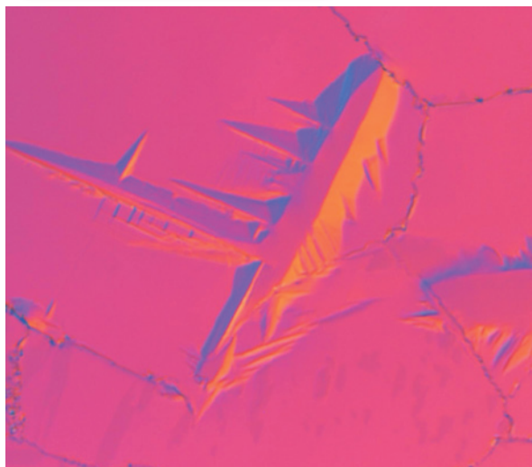
5%ピクラールでエッチングしたプラスチック用金型鋼、高倍率でいくつかの特異な針状組織とプレート状組織が見える。その他はアモルファスのマルテンサイト (倍率: 1000x, DIC)
