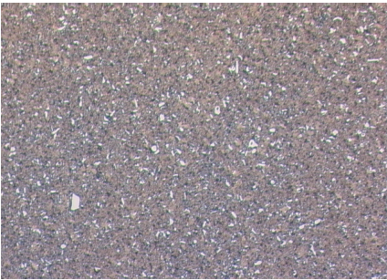
図4: 10% ナイトールでエッチングされた冷間加工された工具鋼、一次炭化物は白く際立つ (倍率:100x)
