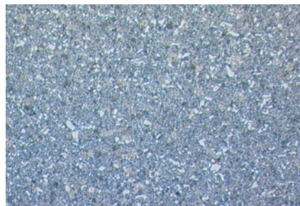
図7: 完全に熱処理された冷間加工用工具鋼 微細な二次炭化物の散乱と小さな白色の一次炭化物が見られる(倍率: 200x)
