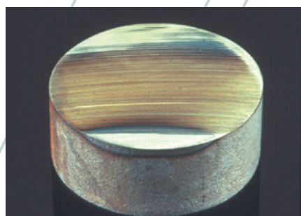
図1: 間違った切断条件による熱損傷
