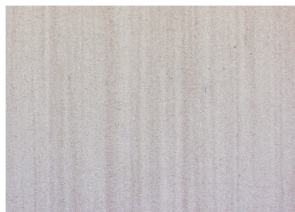
図8: 偏析が見られる熱間加工用工具鋼 (倍率: 100x)
