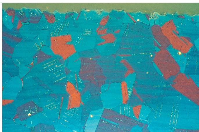
2. 良好的边缘保护, 不锈钢 放大: 500x, 蚀刻剂: Beraha I
