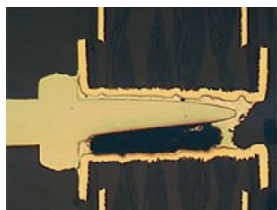
电镀通孔焊接中的大空洞。50 倍
