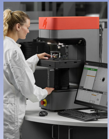
Automatisches Härteprüfgerät DuraVista-40
