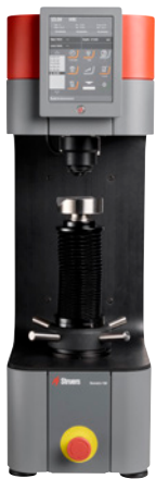
Rockwell Härteprüfgerät DuraVigo-150
