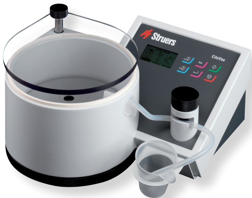
CitoVac permet de remplir de résine tous les pores ouverts sur la surface. Cela renforce les matériaux fragiles et prévient les arrachements et fissures lors de la préparation
