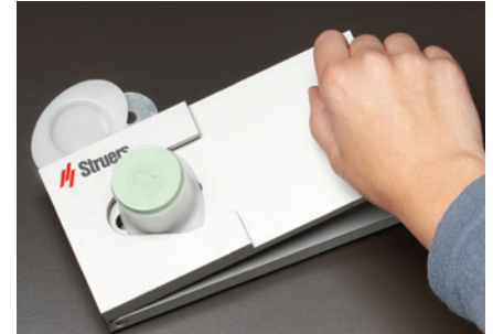
Avec précaution, l'enrobage est pressé en dehors de FixiForm
