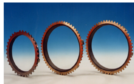
耐摩耗性のためにモリブデンをフレイム溶射された真鍮シンクロナイジングリング
