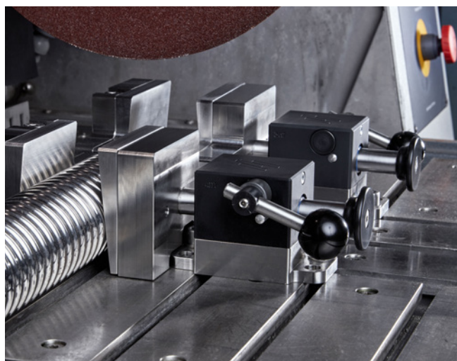
Outil de bridage rapide, côté gauche, 12 mm avec mors prismatiques, en position pour des opérations de tronçonnage en série.
