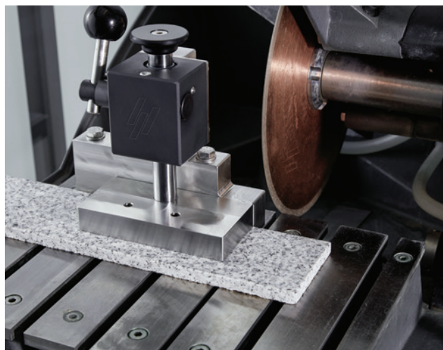
Outil de bridage vertical adapté aux petites pièces de forme régulières.
