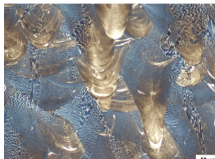
图 27. 用改性的 Klemm (10/3) 和盐酸添加剂蚀刻后的工具钢 1.2709。
