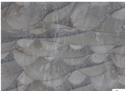
图 25. 铬镍铁合金 718, 用 Adler 蚀刻剂蚀刻。明场。
