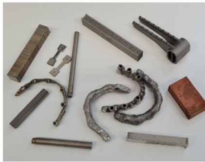
图 8. 通过增材制造（激光熔化工艺）制备多种金属样品。
