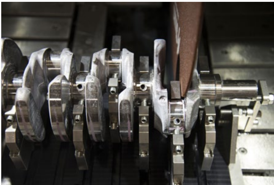
Figura 7: Un disco de corte convencional de 432 x 3 mm permite únicamente una imprecisión muy limitada en el eje X. El disco de corte premium tiene un grosor de 2,7 mm.
