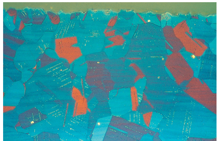
2. Bonne netteté des bords, acier inoxydable Mag : 500x ; réactif d'attaque : Beraha I
