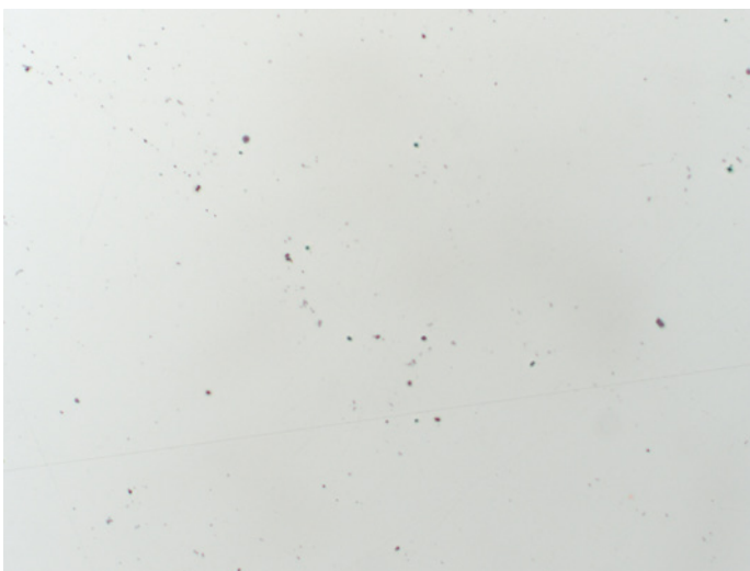
Résultat final de la préparation MD Nap (x 200) Acier trempé.
