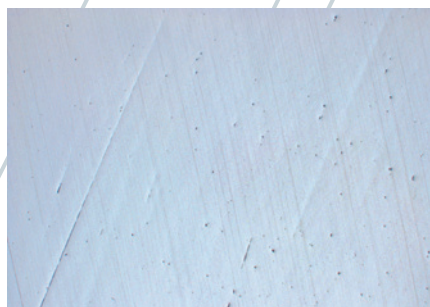
Superficie del acero inoxidable tras pulido final de 3 µm, con deformación del esmerilado
