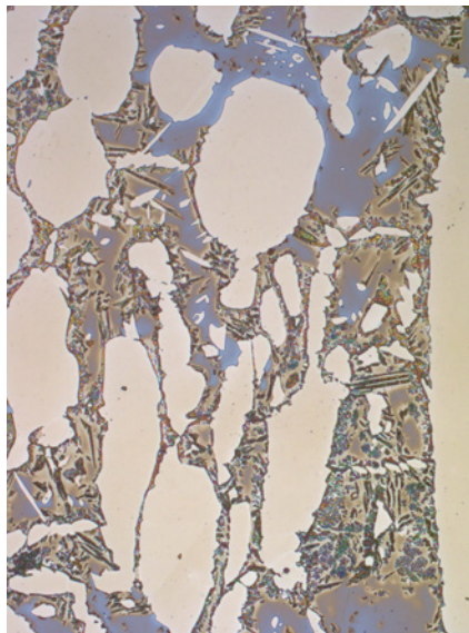
Fig. 10: Acero combinado forjado que muestra ferrita azul, austenita blanca y finas agujas de fase sigma, sometido a ataque electrolítico con 40 % de solución acuosa de hidróxido de sodio. 150x
