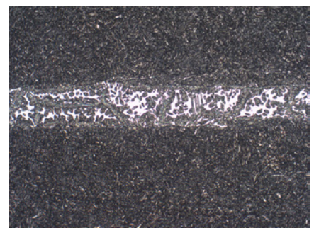
Fig. 6: Acero martensítico templado acero con ferrita delta, sometido a ataque con ácido pícrico
