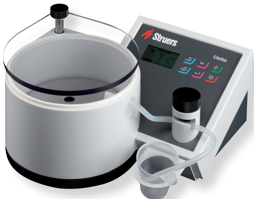
Mit CitoVac können alle Poren, die zur Probenoberfläche geöffnet und verbunden sind, mit Harz gefüllt werden. Dadurch kann das Einbettharz zerbrechliches Material stützen und Ausbrüche und Risse während der Präparation werden vermieden
