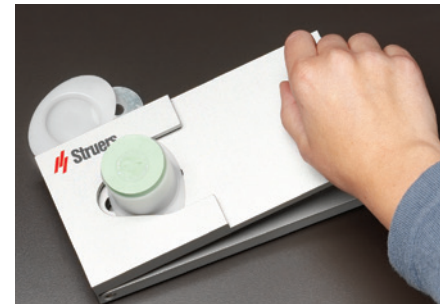
Die Einbettung wird vorsichtig aus der Einbettform gedrückt
