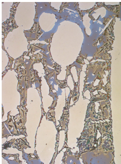
図10: 青色のフェライト、白色のオーステナイト、細い針状のシグマ相、40%水酸化ナトリウムで電解エッチングされた鍛造二相鋼。
