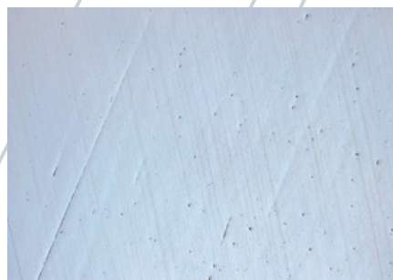
3µm 研磨後のステンレス鋼の表面には研磨による変形がみられる DIC 25x
