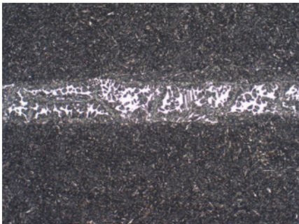
図6: デルタフェライトを含み焼き戻されたマルテンサイトステンレス、ピリン酸でエッチング 75x
