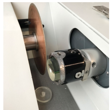
Corte con máquina de precisión Accutom; próximo al objetivo y sin deformación.
