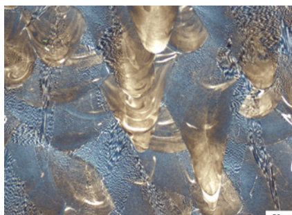
Figura 27. Acero para herramientas 1.2709 después del ataque químico con Klemm modificado (10/3) y adición de HCl
