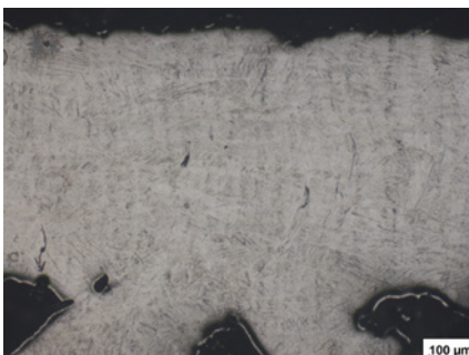
Figura 15. Aleación de titanio en modo de campo claro. Preparación electrolítica con A3, campo claro sin embutir.
