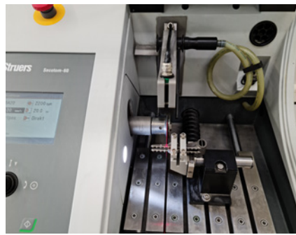
Figura 12. Sujeción de una muestra de titanio de AM en Secotom-60
