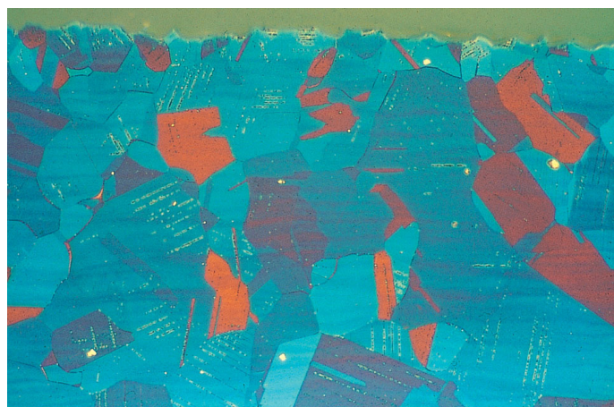
2. 良好なエッジ保持、ステンレス鋼 倍率:500x、エッチング液:Beraha I
