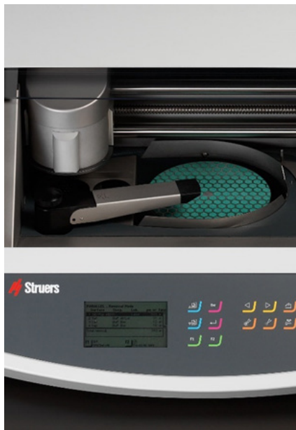
Figure 30. Struers Target Master pour enlèvement de matière contrôlé.
