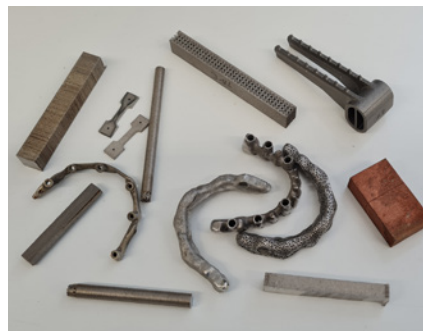
Figure 8. Variété d'échantillons métalliques créés par fabrication additive (processus de fusion au laser).
