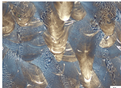
Figure 27. Acier à outils 1.2709 après attaque avec réactif de Klemm modifié (10/3) et ajout de HCl.
