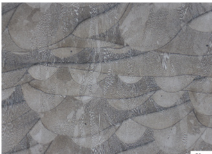
Figure 25. Inconel 718, attaque avec réactif d'Adler. Fond clair.
