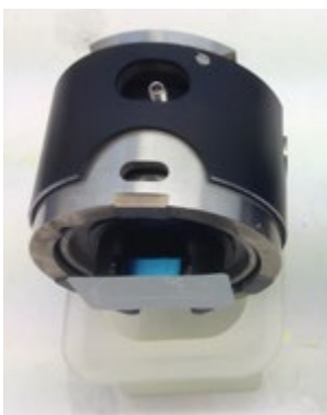
図3: サンプルをサンプルチェアに取り付けた状態
