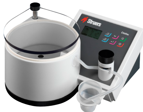
CitoVac facilita la impregnación de materiales frágiles.
