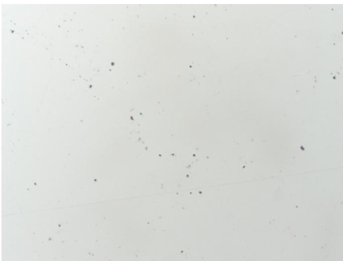
Finales Präparationsergebnis MD Nap (x 200) Gehärteter Stahl.
