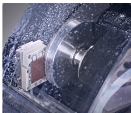
Prépolissage à l'aide de la meule boisseau sur Accutom-100.
