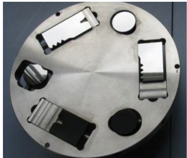
図5: 研磨および琢磨工程でカスタマイズされた試料ホルダーを使用して形状の異なる6個の試料を同時に固定した様子
