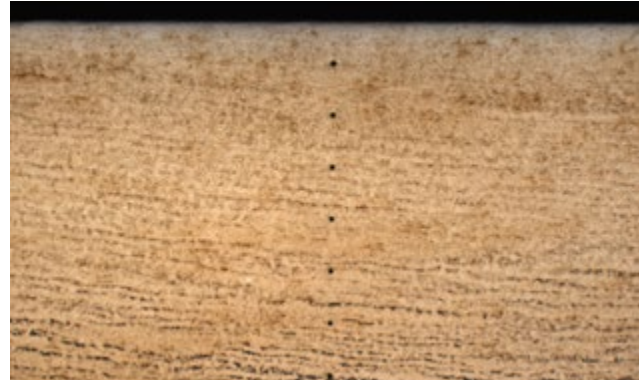
図1:自動硬化層深さ測定（CHD）工程における硬さ試験の最終結果
