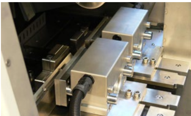
图示 4: 切割设备改为装配有自动进给系统，图示手动夹紧程序，切割每个截面仅需 1 分钟，可连续进行。
