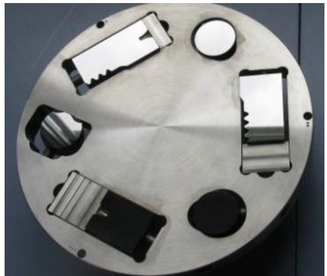
图示 5: 在研磨和抛光 6 个不同形状的试样的过程中，使用一个定制的试样夹具座。
