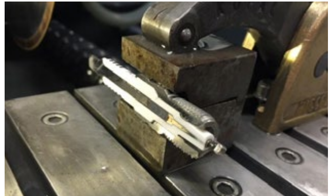
图示 1: 在对试样表面不造成机械损伤的情况下将火花塞切割成两半的最终结果。
