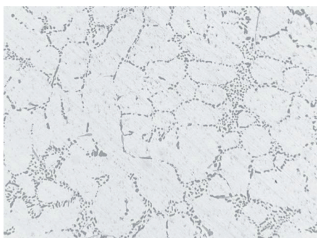
Fig. 9: Fundición de aluminio-silicio; después de un pulido con diamante de 3 \mu\text{m} todavía hay pequeñas rayaduras visibles. 200x
