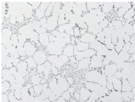
Fig. 10: Estructura como en la Fig. 9, pero con pulido fino con una suspensión OP-U. La matriz está bien pulida y el eutéctico tiene un mayor contraste. 200x
