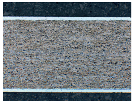
Lámina chapada, núcleo: Aleación de aluminio 2024, recubrimiento: Aluminio 99,5%, ataque químico con Dix y Keller. 50x
