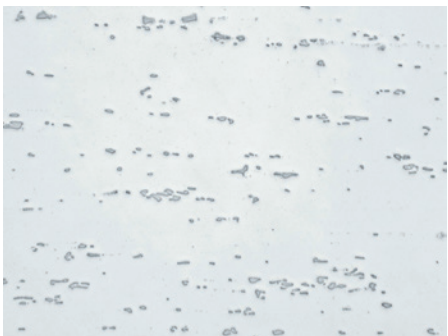
Fig. 5: Como en la Fig. 4, laminado en caliente, sin ataque químico.
