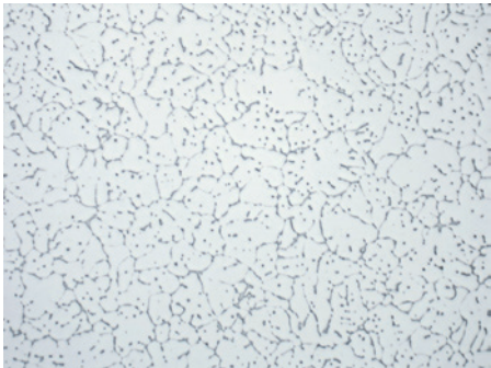
Fig. 3: Aleación de aluminio 2024, para fundición, que muestra precipitación eutéctica en los límites del grano, sin ataque químico, 200x.
