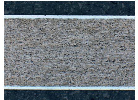
メッキ板、芯部：アルミニウム合金 2024、メッキ：アルミニウム 99.5%、Dix and Keller試薬でエッチング、50x
