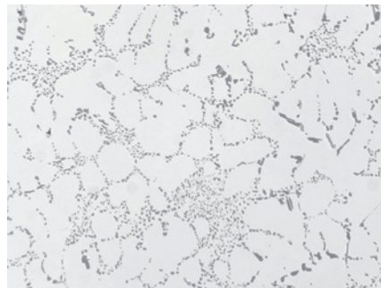
図10: 図9をOP-U懸濁液で精密に琢磨した後。基材が十分琢磨され、共晶がより明瞭なコントラストを示している、200x
