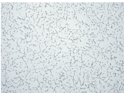
図3: アルミニウム合金2024、鋳造、粒界での共晶析出、エッチングなし、200x
