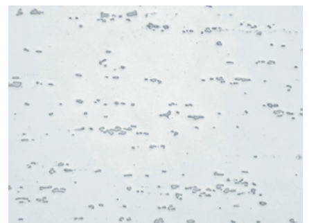
図5: 図4と同様、熱間圧延、エッチングなし、200x
