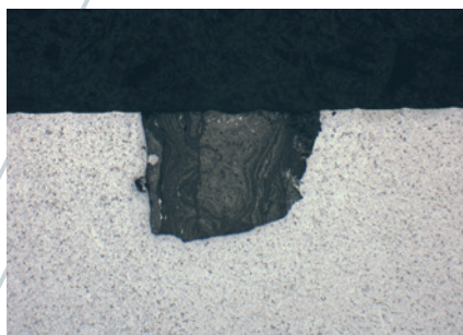
図2: アルミニウム加圧ダイキャストの表面の酸化物、50x
