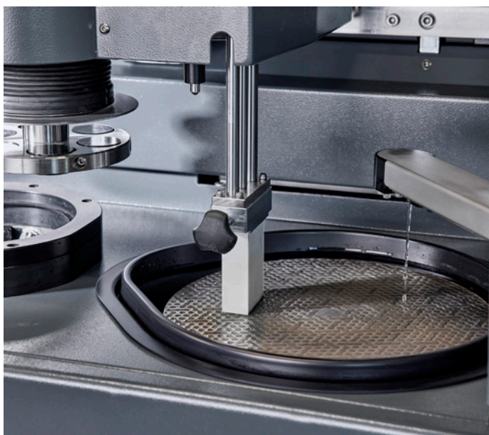
Abrichten von MD-Piano mit einem Aluminiumoxidstein.
