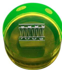
蛍光染料のエポダイを樹脂と混ぜることで、蛍光灯下での試料検査時に孔部や亀裂を識別しやすくなります。
