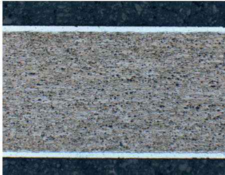
Tôle plaquée, alliage de base : 50x Alliage d'aluminium 2024, placage : Aluminium à 99,5 %, attaqué au réactif de Dix et Keller.
