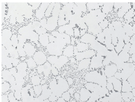
Fig. 10 : Structure identique à celle de la Fig. 9, mais avec un polissage fin réalisé avec la suspension OP-U. La matrice est bien polie et l'eutectique est plus contrastée. 200x
