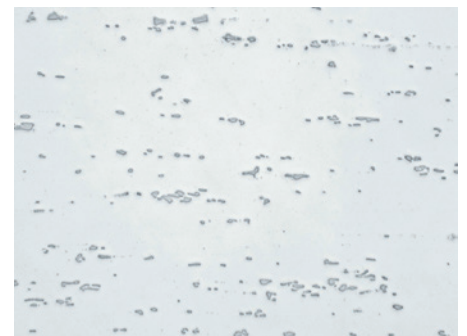
Fig. 5 : Comme à la Fig. 4, laminé à chaud, sans attaque, grossissement 200x.
