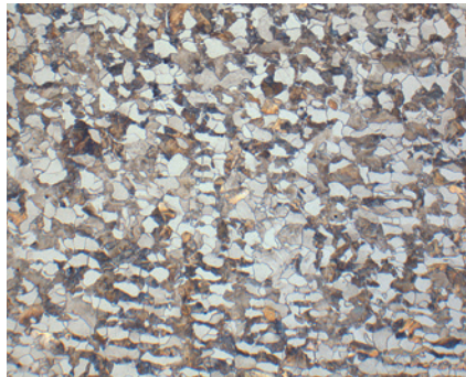
Fig. 7: Acier C45 attaqué au Nital 3%. La phase blanche est de la ferrite et le reste de la perlite. Microscope optique. BF, grossissement original 200x.
