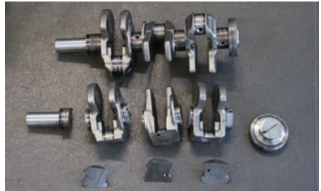
图示1: 进行13次切割，制作出硬度测试所需的试样。
