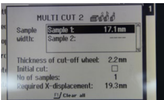
图示8: 切割轴承表面的切割程序。
