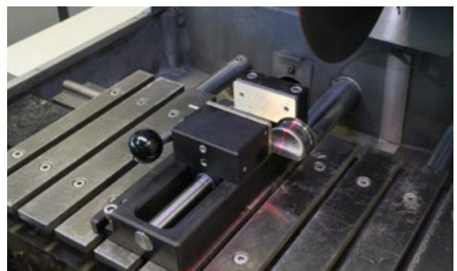
图示9: 使用座板夹具进行最后的切割。
