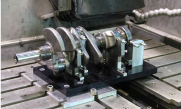
图示4: 已经安装曲轴准备进行横截面切割的夹具。
