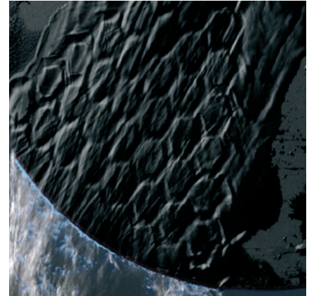
Durch die 3D Oberfläche wird das Wasser, das in die Kanäle zwischen den Sechsecken gespritzt wird, in den Trennschnitt transportiert. Die Probe wird dadurch noch effektiver gekühlt.
