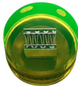
Der fluoreszierende Farbstoff EpoDye wird mit Einbettmittel gemischt, um Poren und Risse bei der Untersuchung der Probe unter fluoreszierendem Licht besser erkennen zu können
