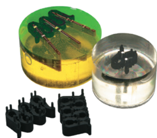
MultiClips können bis zu fünf kleine, dünne Proben aufnehmen.
