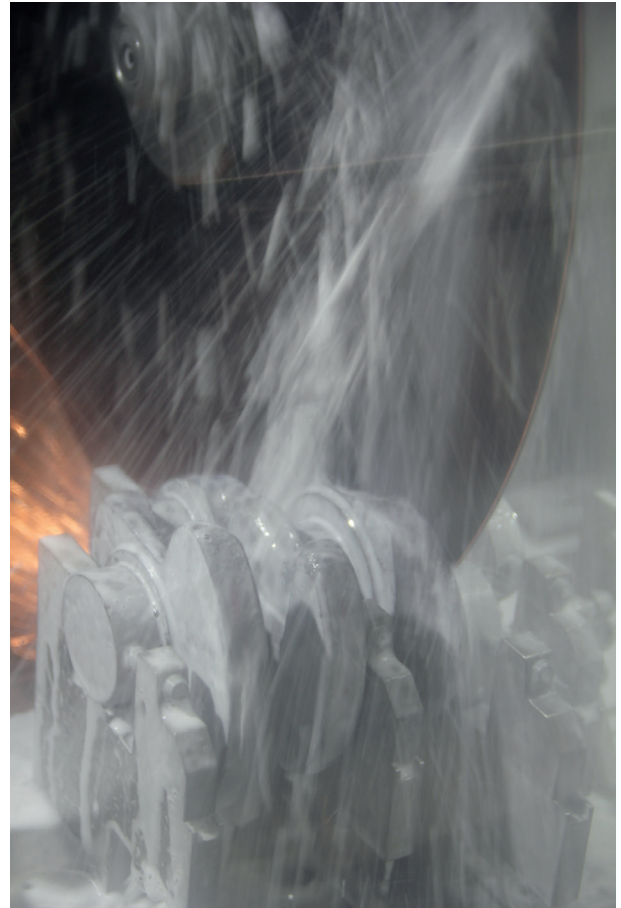
図1: カスタマイズされたクランプ内で切断されているクランクシャフト
