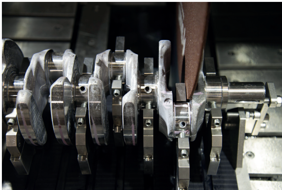
図7: X 軸でのみ多少の不正確さが容認されている従来の 432 x 3 mm 切断ホイール。プレミアム切断ホイールは厚さ 2.7 mm
