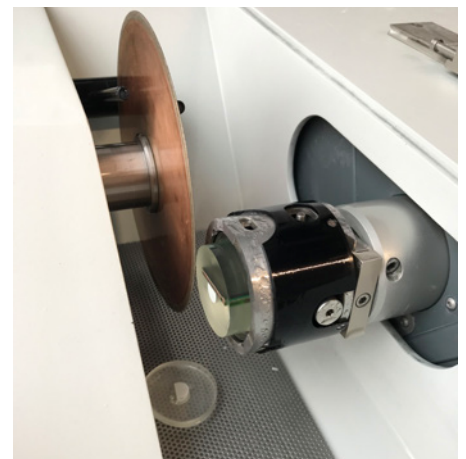
対象付近まで変形を伴わないアキュトム精密切断機での切断。
