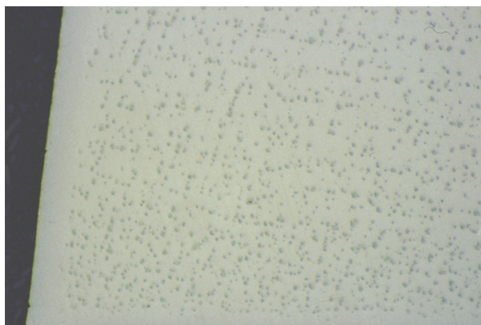
Fig. 7: Titanio después del pulido con diamante de 3 µm, la deformación y los arañazos no se eliminan.
