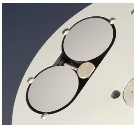
デュアルクランプ - 2 つの試料を 1 つのねじで固定します。
