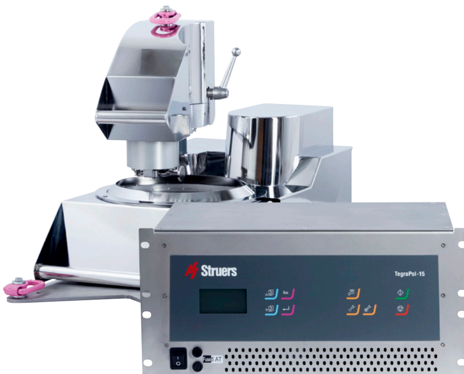
L'unità di controllo di TegraSystem R è rimovibile – può essere posizionata sul retro di TegraSystem MSM o in un'altra posizione consono.
