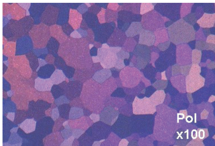
図8: 電解研磨された工業用純チタン棒材の断面、偏光観察、100倍。
