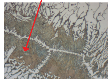
オーステナイト系ステンレス鋼溶接部の研磨・エッチング部分。島状のデルタフェライトと小領域のパーライトを示す
