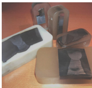
さまざまな溶接の長方形の埋込み。
