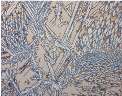
同材料。溶接微細構造は、主にデルタフェライトとオーステナイトで構成されている。 明視野、200x。
