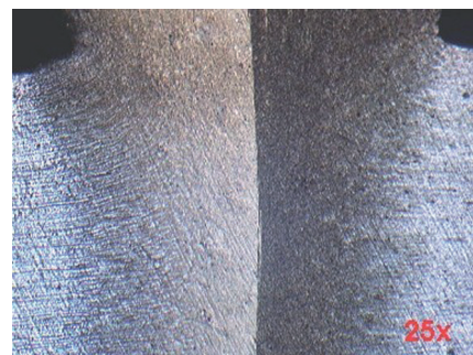
図3: 熱影響部および関連塑性変形を示す、圧力摩擦溶接による低合金鋼の融合インターフェイス。明視野、25x。
