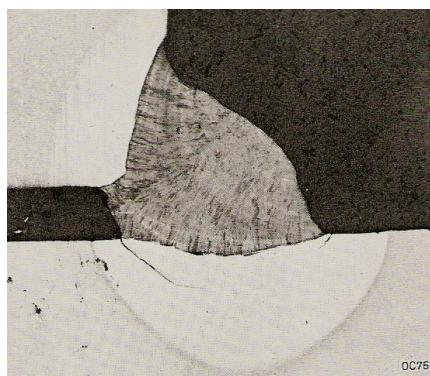
低合金鋼の隅肉溶接部の下の熱影響部の割れ。明視野、5x。
