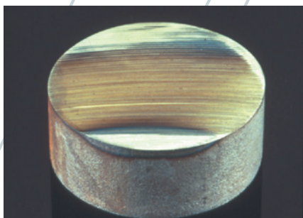
Abb.1: Thermische Schäden erzeugt durch falsche Trennbedingungen
