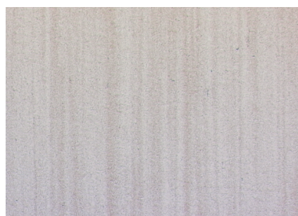
Fig. 8: Warmarbeitsstahl mit Entmischungen
